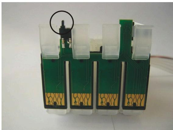
После этого картриджи должны быть опознаны принтером. Если же этого не произошло, попробуйте потереть чипы (блестящую часть) стирательной резинкой и еще раз установить картриджи, плотнее вставить в каретку.
