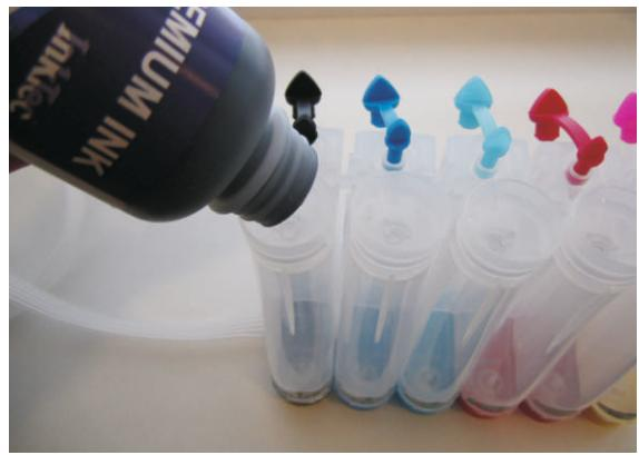
После заправки всех емкостей выньте воронки и плотно закройте отверстия цветной заглушкой. Воронки необходимо тщательно промыть проточной водой, чтобы в дальнейшем использовать для дозаправки СНПЧ. Затем в каждый из воздушных отсеков поместите воздушный фильтр, предотвращающий попадание пыли в процессе эксплуатации СНПЧ, как показано на рисунке:
