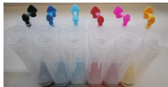
После заправки всех емкостей выньте воронки и плотно закройте отверстия цветной заглушкой. Воронки необходимо тщательно промыть проточной водой, чтобы в дальнейшем использовать для дозаправки СНПЧ. Затем в каждый из воздушных отсеков поместите воздушный фильтр, предотвращающий попадание пыли в процессе эксплуатации СНПЧ, как показано на рисунке:
