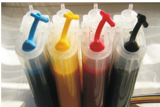
**Важно!** Обычно емкости располагаются на одном уровне с принтером. Если при печати случается частое пропадание нескольких дюз и прочистки не помогают, можно попробовать установить емкости на 2-3 см выше относительно принтера.
